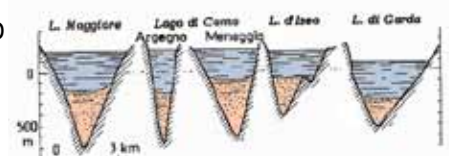
Profilo laghi prealpini la forma a V indica l'origine fluviale la profondità dei canyon superava i 1.300 m
